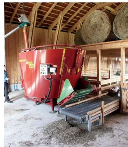
Foto 15 und 16 | links: Futterband, rechts: stationärer Mischer
