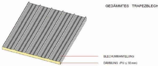
Abb. 4 | gedämmtes Trapezblech, © LK OÖ Bauberatung
