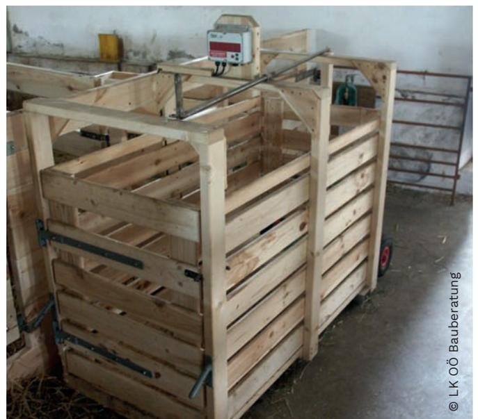
Foto 32 | Mobile Tierwaage
